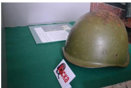
*состоит из: корпуса; подтулейного устройства; подбородного ремня. Корпус выполнен из легированной броневой стали марки 36СГН толщиной 1,2 мм.*
