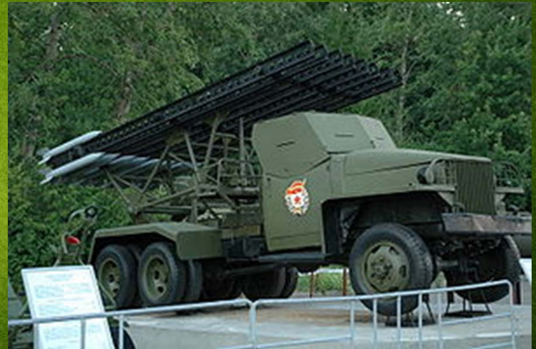
Реактивная установка БМ-13 на шасси автомобиля Студебекер ЮС6 (на вооружении с 1943 г.)
